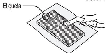
Remova delicadamente o pó do filtro HEPA e do filtro desodorizante com um acessório ou peça semelhante de um aspirador.
