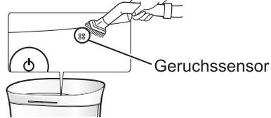
Entfernen Sie vorsichtig den Staub von der hinteren Abdeckung – mit einem Staubsaugeraufsatz oder einem ähnlichen Werkzeug.
