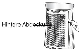
Entfernen Sie mit einem Staubsauger oder einem ähnlichen Werkzeug vorsichtig den Staub von der hinteren Abdeckung.
