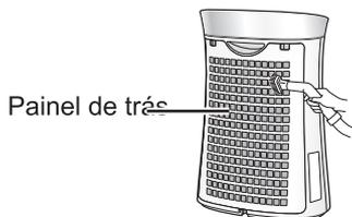
Remova delicadamente o pó do painel de trás com um acessório ou peça semelhante de um aspirador.
