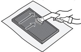
Ostrożnie, przy pomocy odkurzacza lub podobnego urządzenia, usuń kurz z filtra HEPA i filtra pochłaniającego zapachy.
