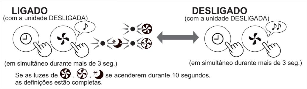
**DESLIGADO** (com a unidade DESLIGADA)
