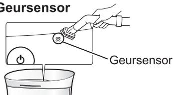
Verwijder voorzichtig al het stof van de geursensor met het borstelhulpstuk van een stofzuiger of een vergelijkbaar gereedschap.
