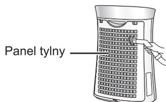
Ostrożnie, przy pomocy odkurzacza lub innego urządzenia, usuń kurz z panelu tylnego.
