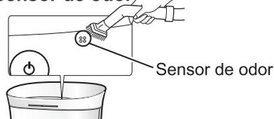
Remova delicadamente o pó do sensor de odor com um acessório ou peça semelhante de um aspirador.
