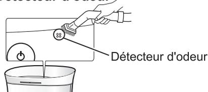
Enlevez doucement la poussière du capteur d'odeur, à l'aide d'un accessoire d'aspirateur ou d'un outil similaire.
