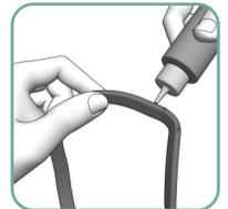
Inserte el borde redondeado de la junta debajo del borde redondo de la tapa. Alinee los orificios de la junta nueva con los orificios de la tapa.
